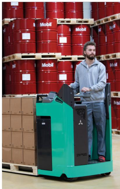
El diseño de las transpaletas eléctricas de conductor montado de pie aloja al operario por completo en la carretilla y lo mantiene protegido por el chasis. El concepto de conductor montado de pie también significa que el equipo ocupa un espacio muy reducido. Este factor, junto con un radio de giro increíblemente reducido, facilita al máximo el diseño de pasillos más estrechos.
