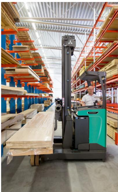
La serie RBM20- 25N3, capaz de manipular tanto cargas largas como palets estándar, ofrece alturas de elevación de hasta 9,7 metros. Al ser multidireccional y poder transportar cargas largas a los lados, los pasillos se reducen al mínimo, lo que le permite maximizar el espacio de almacenamiento.
