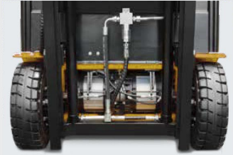
Motores delanteros duales separados.
