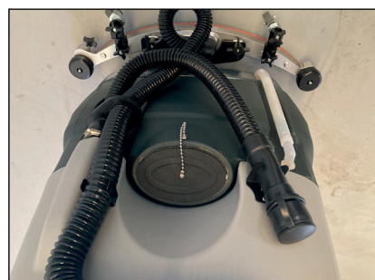
Desmontaje sencillo de las gomas. Tapon del deposito de solución
