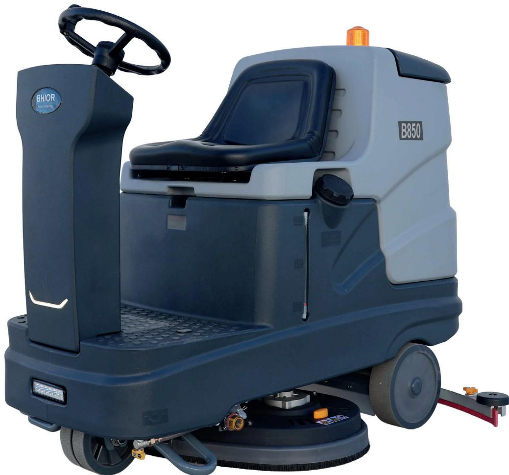
BHIOR B850 es una máquina de conductor sentado diseñada para aumentar la productividad en grandes superficies sin incrementar los tiempos de trabajo. Con 850 mm de ancho de fregado, grandes depósitos y un rendimiento de hasta 5.000 m<sup>2</sup>/h, ofrece máxima comodidad y resultados profesionales.
