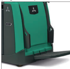
Robusta plataforma de hierro fundido
