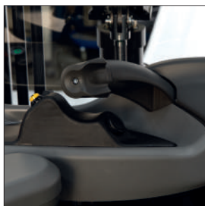
Manillar ergonómico con control de velocidad
