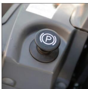
Freno de estacionamiento controlado electrónicamente
