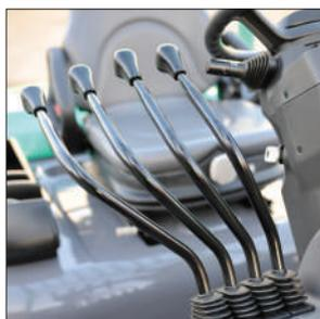
Palancas de control hidráulico
