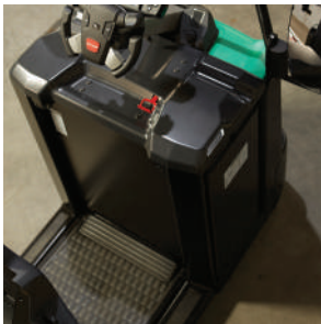
Plataforma del operador suspendida.
