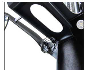
Ventilador en la cabina
